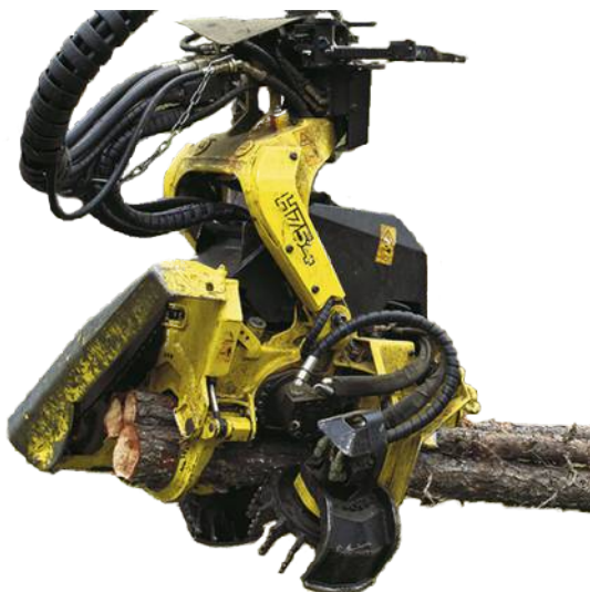
Att. 13 Izmēģinājumos izmantotā H 754 griezējgalva 10 .
