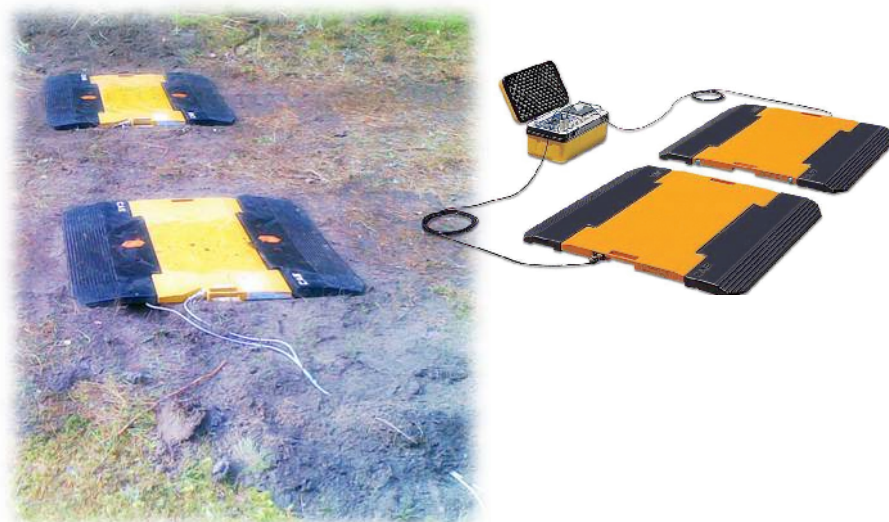
Att. 18: Pievedējtraktora svēršanai izmantotie svāri CAS RW-15P, kopskats un darbam sagatavotas platformas.
