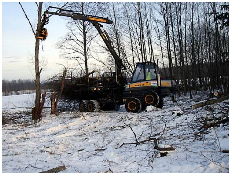
Att. 5 Ar kniebējgalvu aprīkots Ponsse Buffalo pievedējtraktors 6 .
