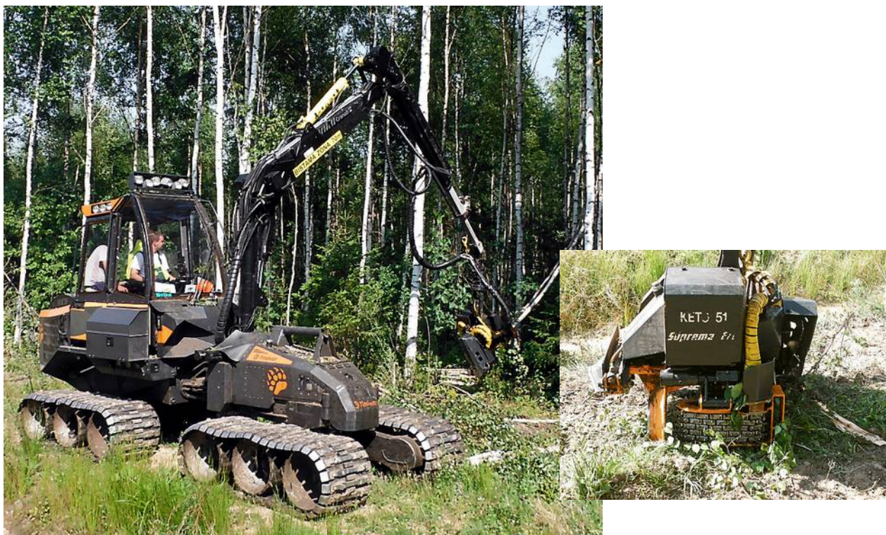
Att. 8: Timberharvesters ar paketējošo griezējgalvu Keto 51 Supreme Ecotilt.
