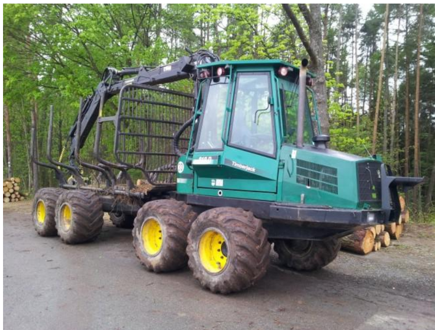
Att. 13: Timberjack 810 B pievedējtraktors 7 .
