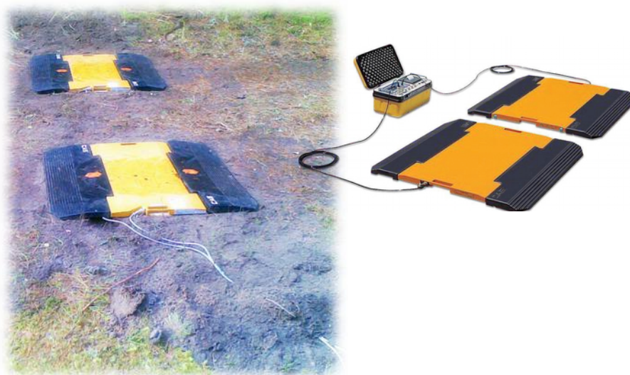
Att. 19: Pievedējtraktora svēršanai izmantotie svāri CAS RW-15P, kopskats un darbam sagatavotas platformas.
