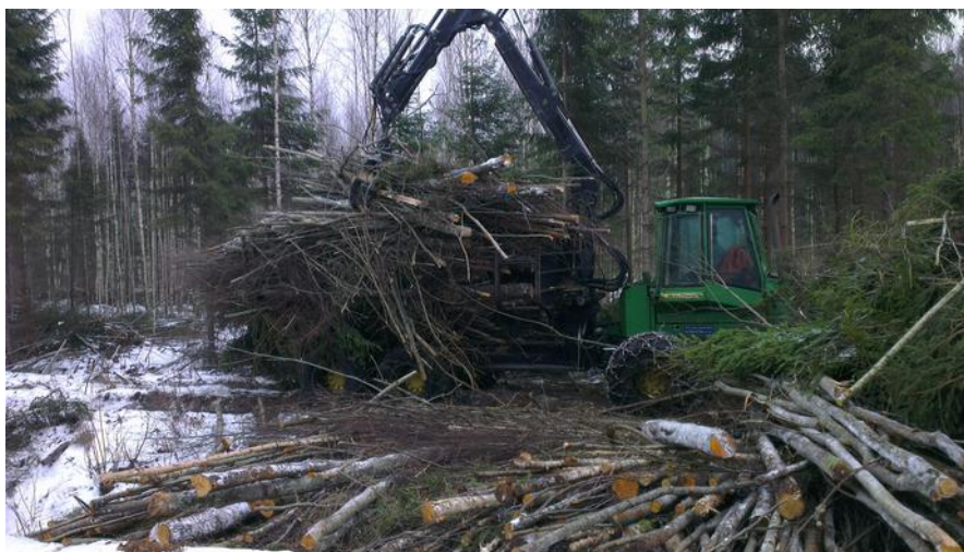
Att. 14: Pievedējtraktors John Deere 1110 E ar garo rāmi.
