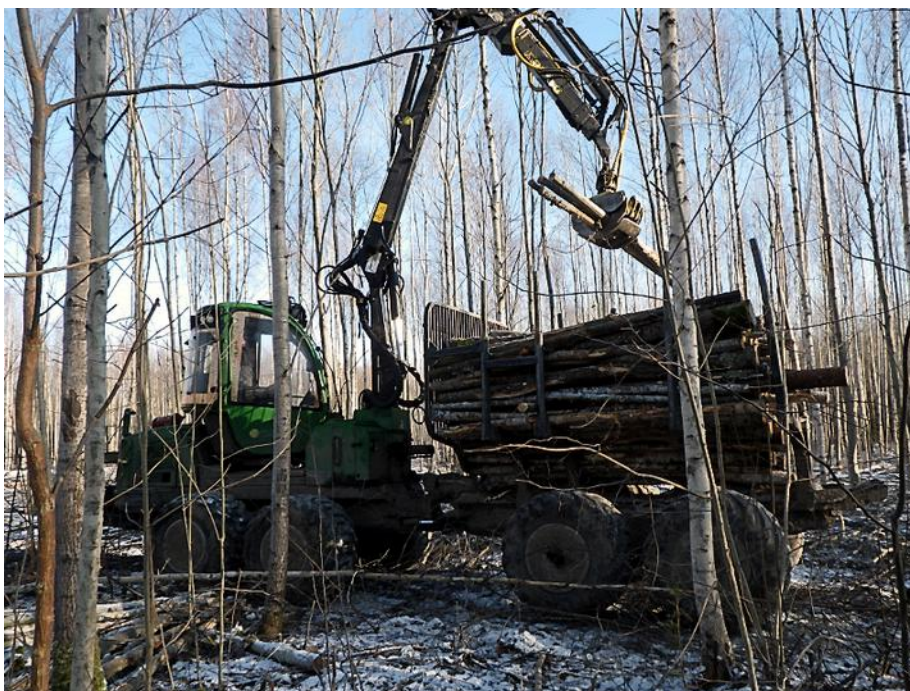
Att. 15: Pievedējtraktors John Deere 1110 E ar īso rāmi.
