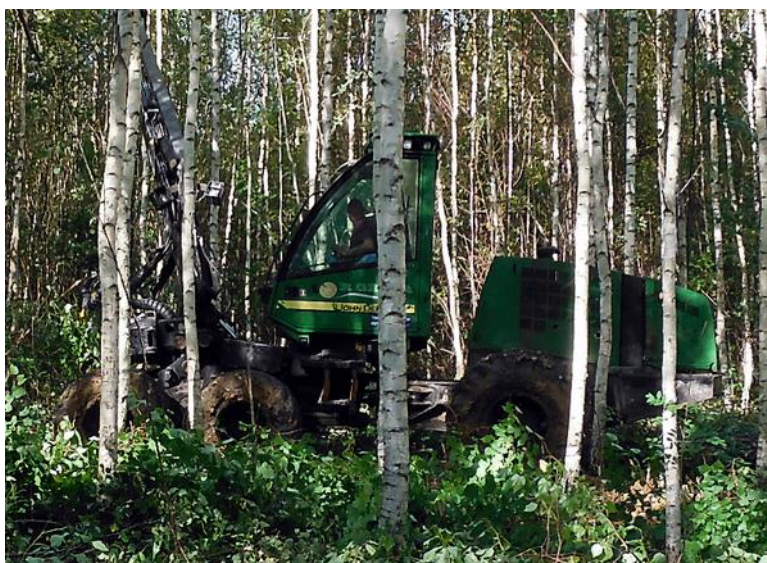
Att. 9: John Deere 1070 ar Bracke C16.b griezējgalvu.
