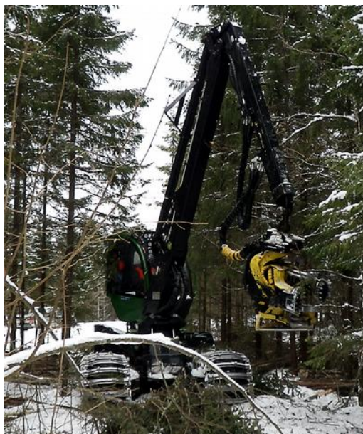
Att. 10: Izmēģinājumos izmantotais harvesters John Deere 1070 E ar griezējgalvu H 754.
