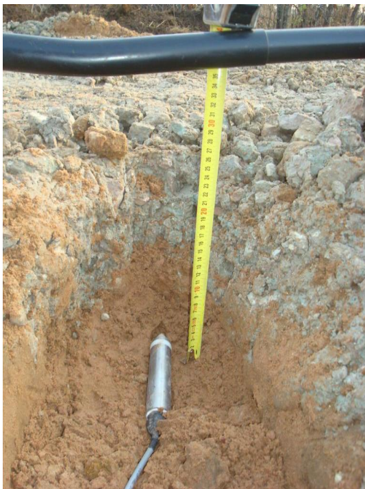
att. 2 Sensoru izvietojums segas konstrukcijā un shēma (attēlā augšējais sensors, kas izvietots tieši zem šķembu kārtas)
