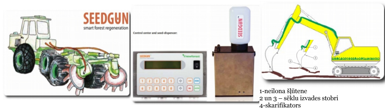
Att. 21: Tiešās sējas iekārta Seedgun ( http://www.newforest.fi/products-e.htm )
