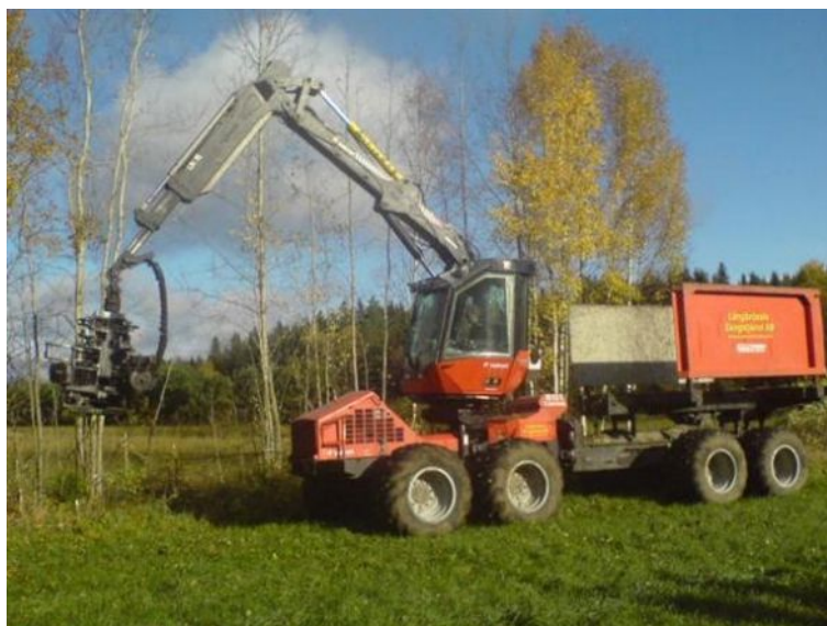
Att. 27 Valmet 801 Combi speciāli aprīkots sīkstumbu apstrādei un pievešanai ( www.annonsborsen.se ).
