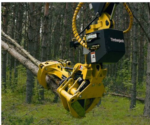
Att. 17 Timberjack 720 nogriešanas-uzkrāšanas mehānisms (CD).
