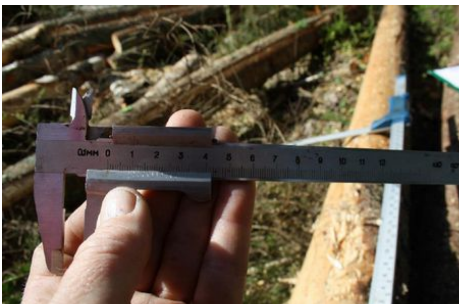
Att. 26: Piektais parauglaukums, centrālā veltna izbūksējums egles z.b. (6x10) koksnē ir sasniedzis 8,5 mm dziļumu.
