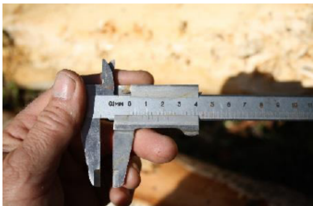
Att. 24: Ceturtais parauglaurums, centrālā veltna izbaksējuma dziļums finierkluča koksnē 7,7 mm.
