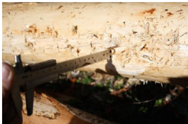
Att. 24: Ceturtais parauglaurums, centrālā veltna izbaksējuma dziļums finierkluča koksnē 7,7 mm.
