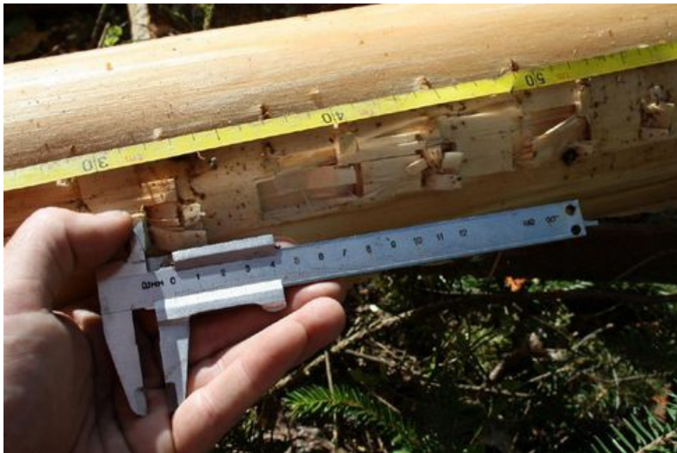
Att. 25: Astotais parauglaukums, dziļākais bojājums egles z.b. (14x18) koksnē sasniedzis 8,3 mm.
