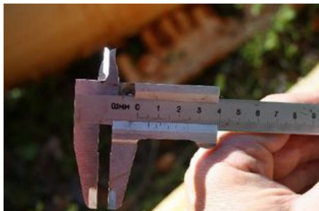
Att. 23: Pirmais parauglaurums, 10 finierkluči, min. iespieduma dziļums 1,5 mm. Maks. iespieduma dziļums 5,3 mm.
