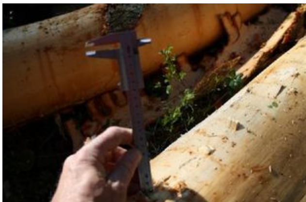
Att. 23: Pirmais parauglaurums, 10 finierkluči, min. iespieduma dziļums 1,5 mm. Maks. iespieduma dziļums 5,3 mm.
