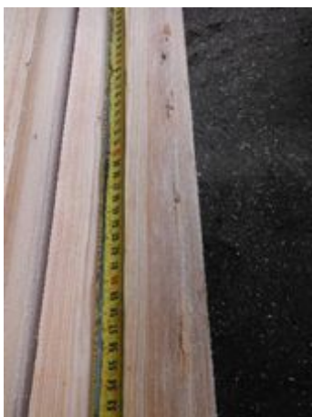
Att. 16: Padeves veltnu iespaidumu uzmērīšana.
