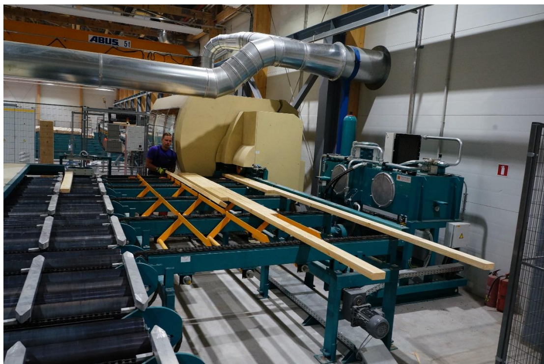
5.1. att. Dēļu pagarināšanas tehnoloģiskā līnija.
