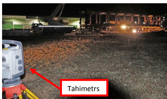
7.5.att. Tahimētra sistēma pārvietojumu mērījumiem.
