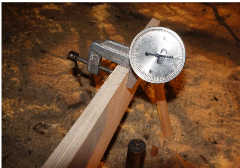
7.6.att. Mehānisko deflektometru sistēma.
