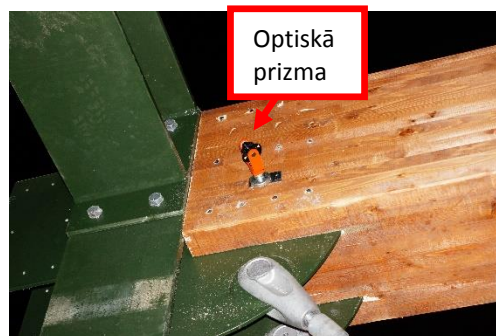
7.5.att. Tahimētra sistēma pārvietojumu mērījumiem.
