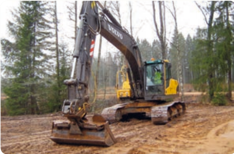
Ekskavators ar planējamo kausu nogāžu veidošanai
