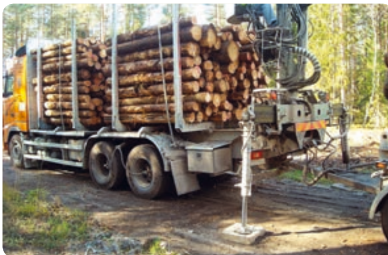
Manipulatora atbalsta paliktņu lietošana
