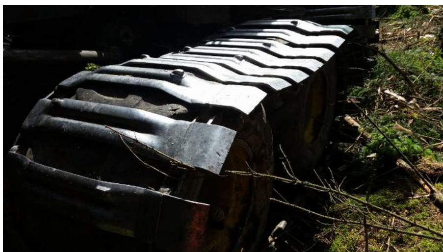
Att. 8: ECO-Baltic ķēdes ar palielinātu virsmas laukumu uz pievedējtraktora 6 .
