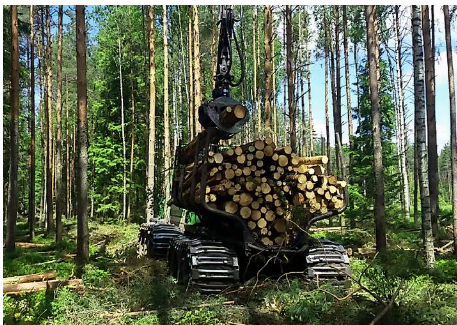
Att. 9: Pievedējtraktors ar standarta platuma ECO-Baltic ķēdēm uz priekšējiem un aizmugurējiem tandēmiem (1. darba metode) 7 .
