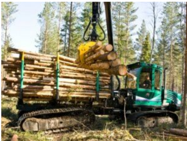
Att. 25 ProSilva pievedējtraktors uz buldozera šasijas 21 .
