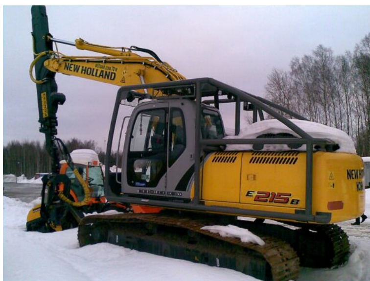
Att. 15 Mežizstrādei pielāgots New Holland E215B ekskavators 11 .
