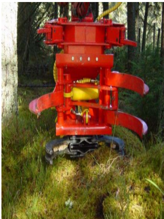
Att. 5 Akumulējošā kniebējgalva Naarva Grip 1500-25E 1 .
