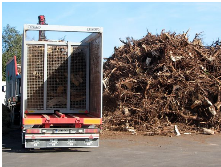
Att. 66 Celmu transportēšanas konteiners ar kompaktizētāju.
