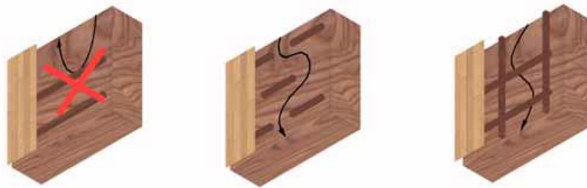
4.24. att. Neveiksmīgs, vidēji labs un labs līstīšu izvietojums vertikālajam apšuvumam [13]
