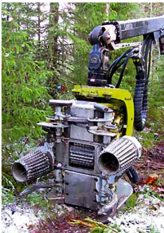
Att. 1: Bracke paketējošās griezējgalvas MAMA prototips (Fulvio & Bergström, 2013)
