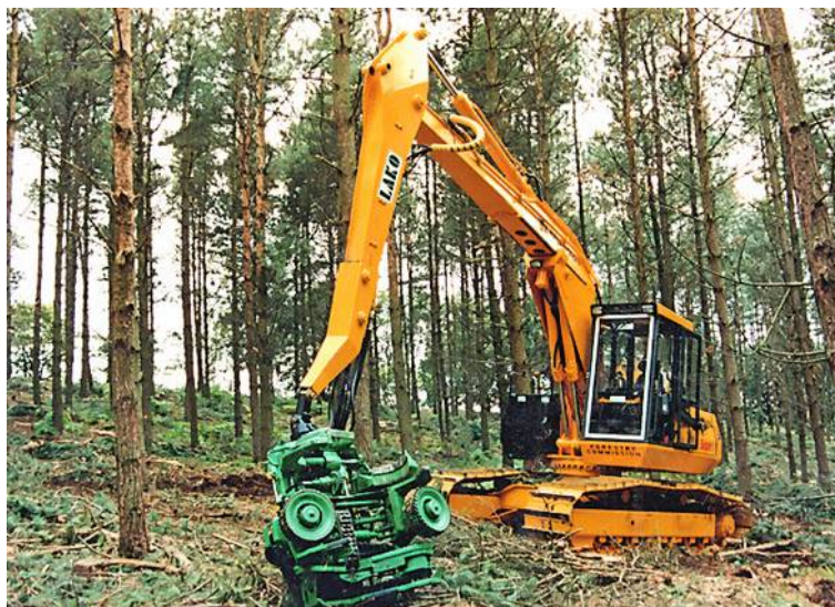
Att. 2 Mežizstrādei pielāgots JCB8147 ekskavators 2 .
