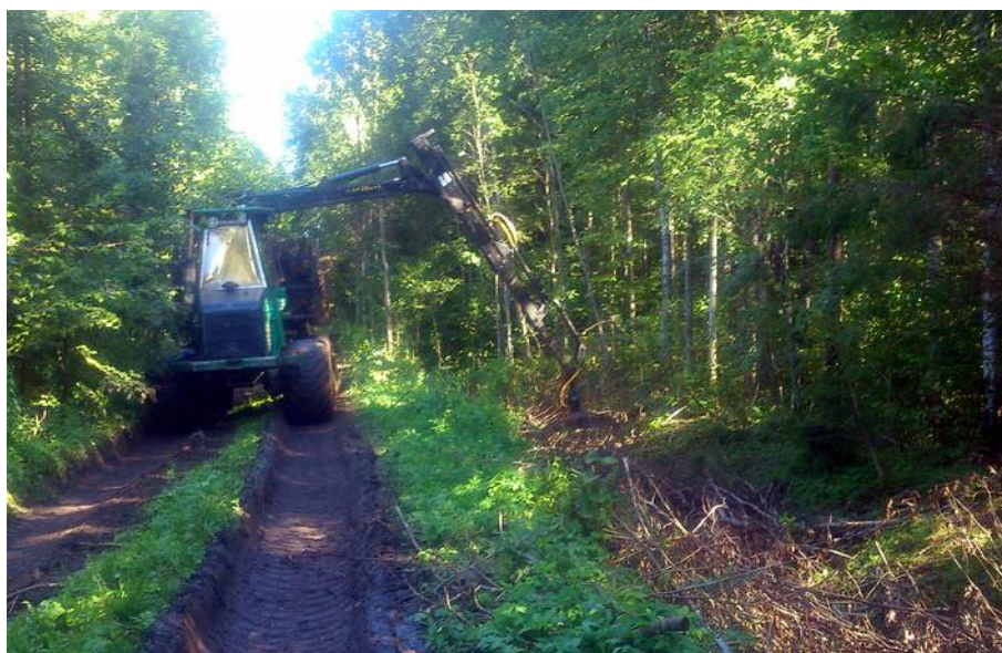
Att. 11: Logset F5 pievedējtraktors.
