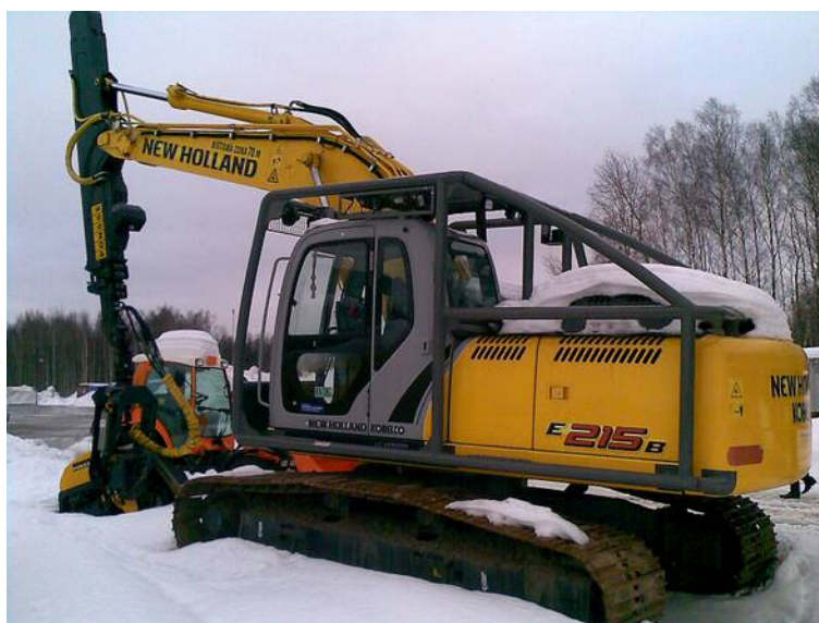
Att. 4 Mežizstrādei pielāgots New Holland E215B ekskavators 3 .
