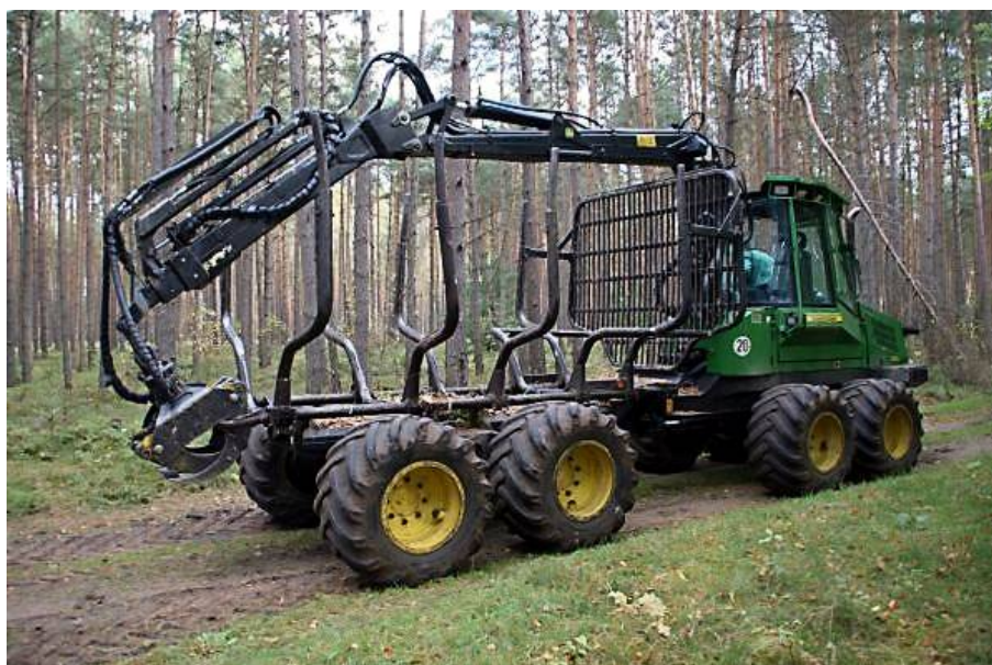
Att. 10: John Deere 810D pievedējtraktors 8 .
