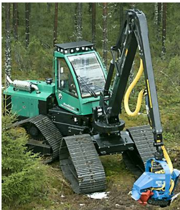
Att. 5 ProSilva harvesters uz buldozera šasijas 4 .
