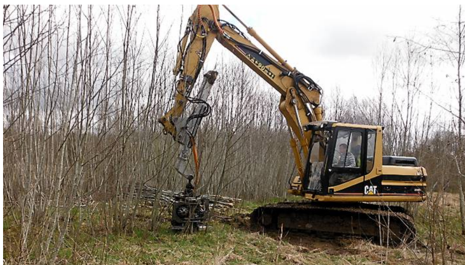
Att. 3 Mežizstrādei pielāgots CAT ekskavators ar paketējošu griezējgalvu un strēles pagarinājumu.
