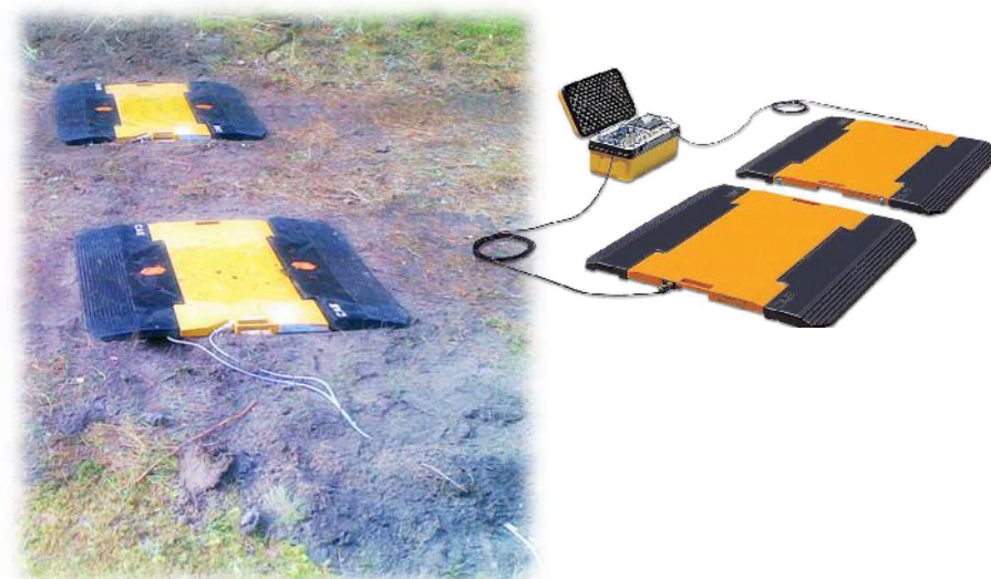
Att. 12: Pievedējtraktora svēršanai izmantotie svari CAS RW-15P, kopskats un darbam sagatavotas platformas.
