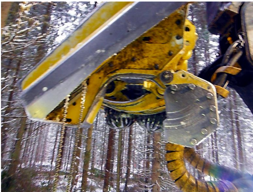
Att. 56: Moipu M 300F3 griezējgalvas kniebšanas mehānisms.
