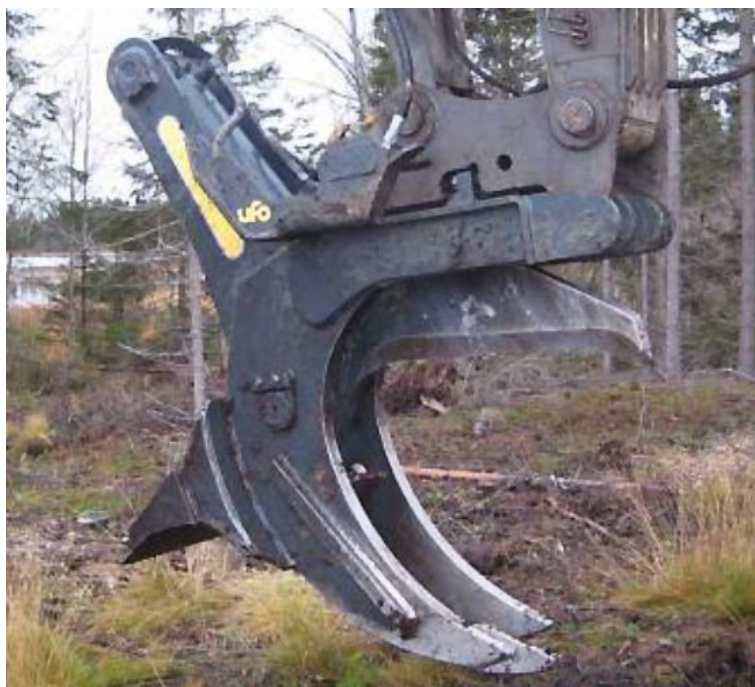
Att. 59: Celmu raušanas kauss Biorex 40 50 .
