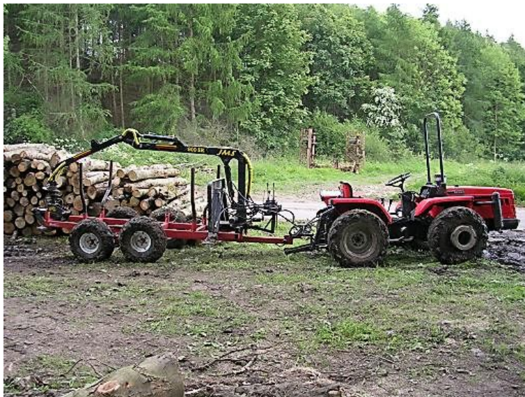
Att. 28 Neliels lauksaimniecības traktors ar aprīkojumu kokmateriālu pievešanai 24 .
