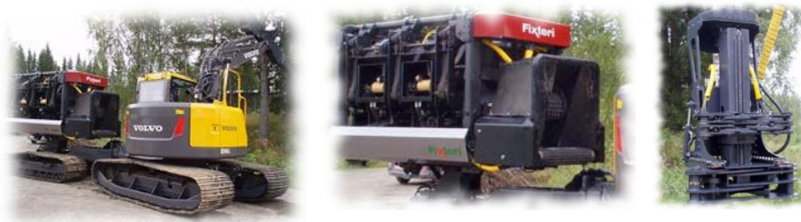
Att. 18 Harvester – saiņotājs Fixteri uz ekskavatora bāzes 14 .
