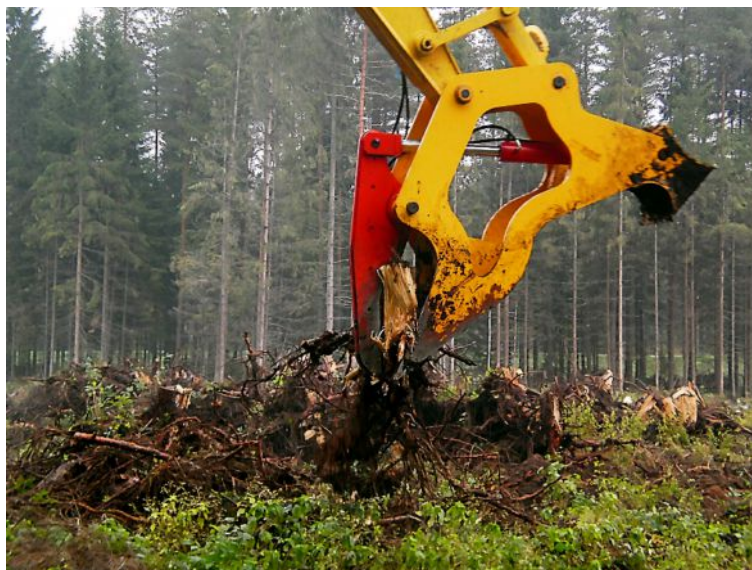
Att. 57: Celmu raušanas un pacilu gatavošanas kauss MCR-500 49 .
