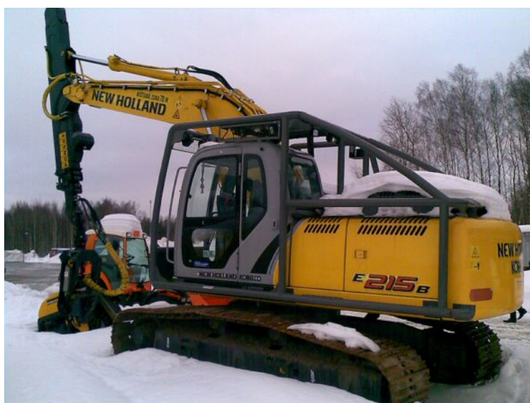
Att. 15 Mežizstrādei pielāgots New Holland E215B ekskavators 11 .
