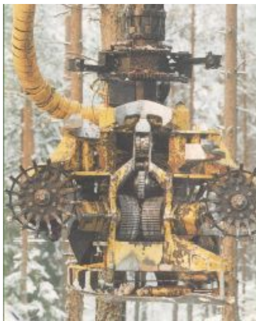
Att. 16 Timberjack 745 agregāts ar uzkrājēju (Timberjack News, 1999).
