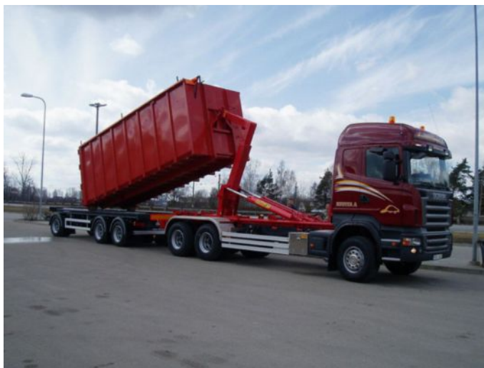
Att. 37 Konteineru tipa šķeldas vedējs 36 .
