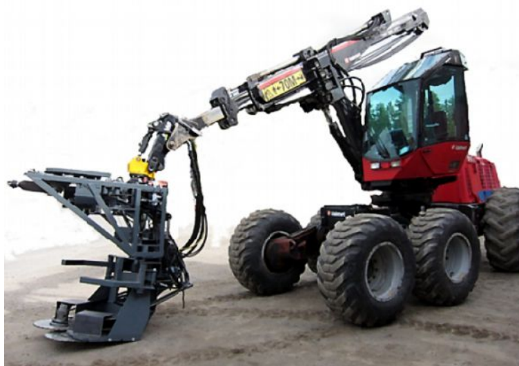
Att. 69 Eksperimentāla sīkkoku izstrādes griezējgalva.
