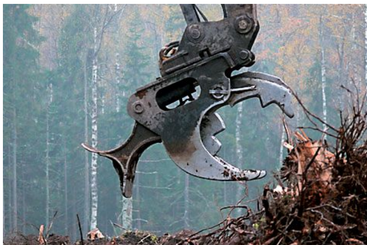
Att. 60: Celmu raušanas kauss ar augsnes gatavotāju 51 .
