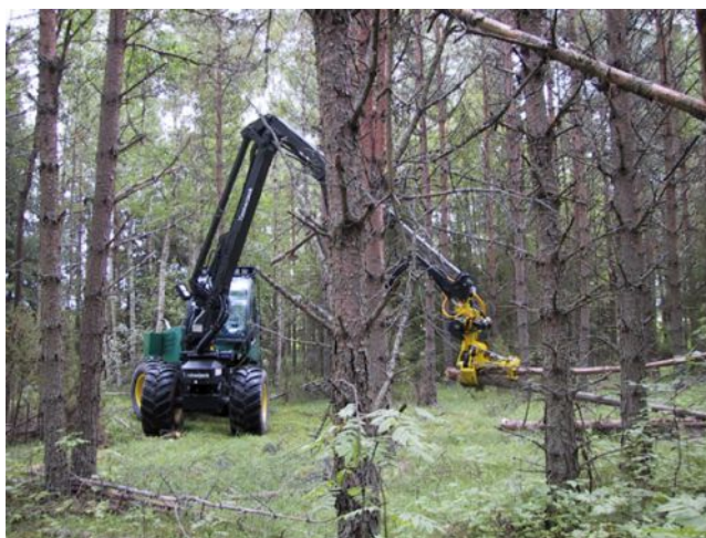
Att. 19 Gāšanas – saiņošanas mehānisms uz John Deere 770 (CD).
