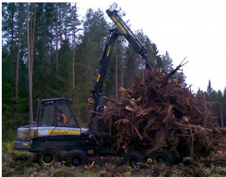
Att. 63 Celmu pievešana ar nepārbūvētu pievedējtraktoru 55 .
