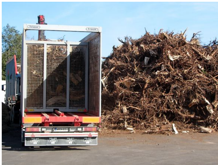
Att. 66 Celmu transportēšanas konteiners ar kompaktizētāju.
