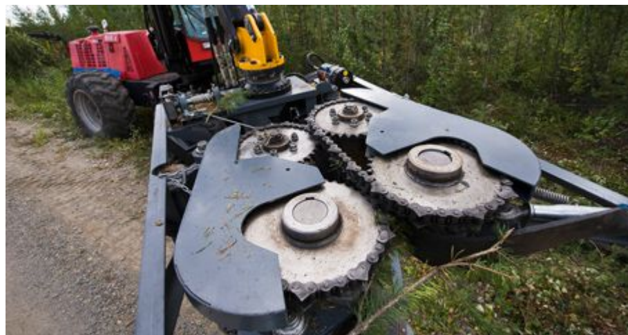
Att. 4. Specializēts uzkrājējmehānisms, kas paredzēts jaunaudžu mehāniskai kopšanai.
