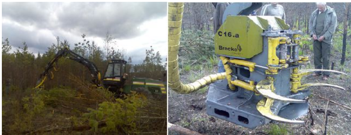
Att. 20 Harvesters OSA aprīkots ar Bracke C 16 uzkrājēj-griezējmehānismu.
