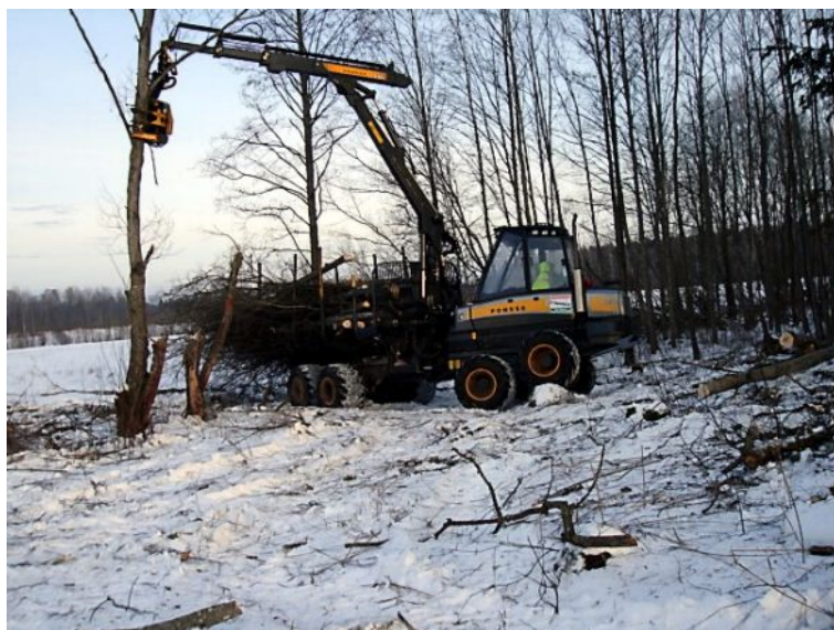
Att. 11 Ar kniebējgalvu aprīkots Ponsse Buffalo pievedējtraktors 7 .
