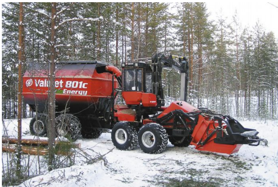
Att. 26 Valmet 801 Combi bioenerģijas ieguvei ( www.biologistiikka.fi ).
