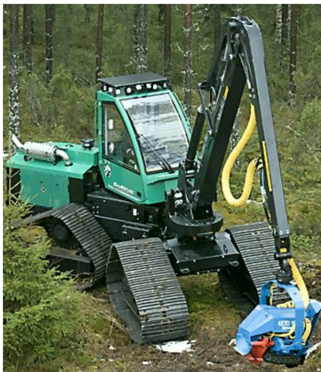
Att. 16 ProSilva harvesters uz buldozera šasijas 12 .
