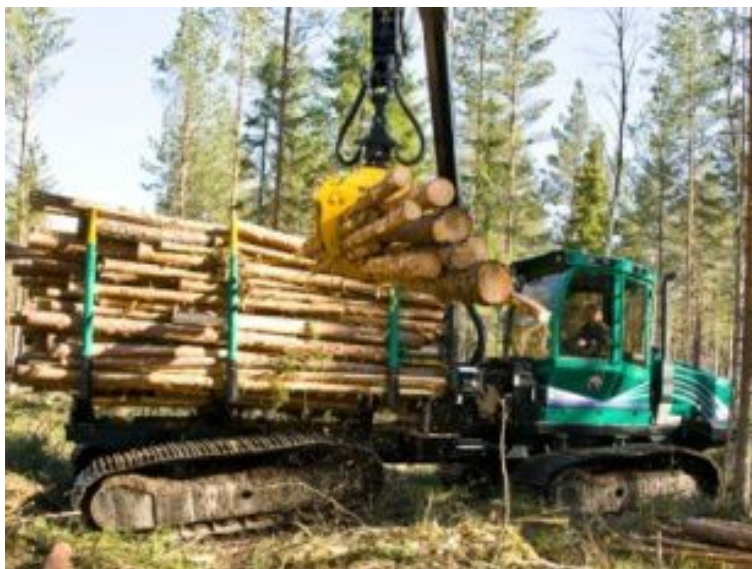
Att. 25 ProSilva pievedējtraktors uz buldozera šasijas 21 .
