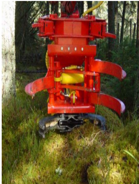
Att. 5 Akumulējošā kniebējgalva Naarva Grip 1500-25E 1 .
