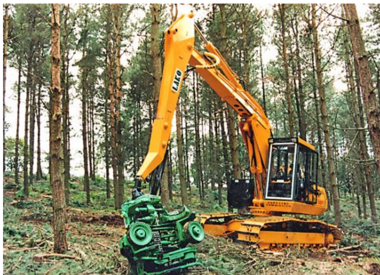
Att. 14 Mežizstrādei pielāgots JCB8147 ekskavators 10 .
