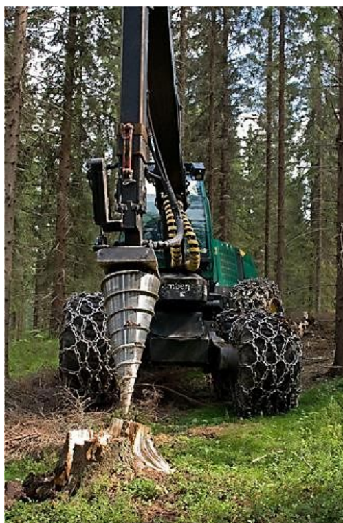
Att. 61 Krājas kopšanas cirtēm paredzēts celmu urbis 53 .
