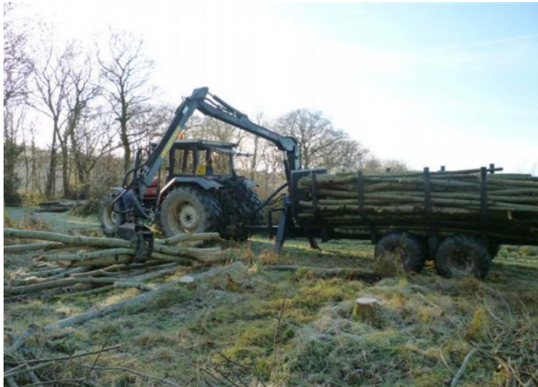
Att. 27 Ford markas traktors, kas pielāgots sīkkoku pievešanai 23 .
