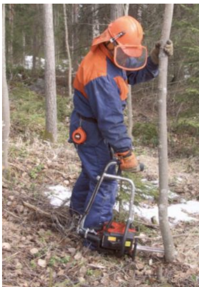
Att. 21 Motorzāģis ar augstajiem rokturiem 18 .
