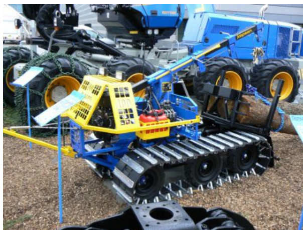
Att. 41 Mazgabarīta tehnika „dzelzs zirgs” 40 .
