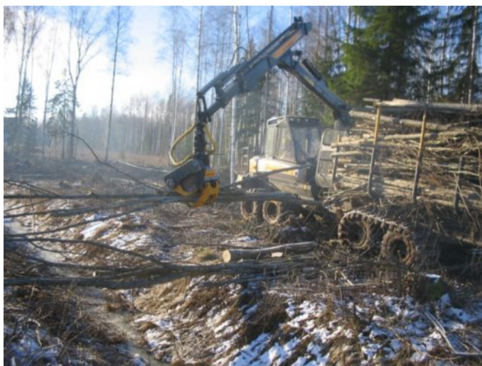
Att. 22 Ponsse Winsent pievedējtraktors aprīkots ar uzkrājēj-kniebēj mehānismu.
