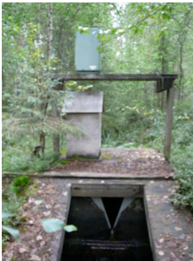
Attēls 34. Noteces mērijumu pārgāzne Jupajokki/Konilampi sateces baseinā.
