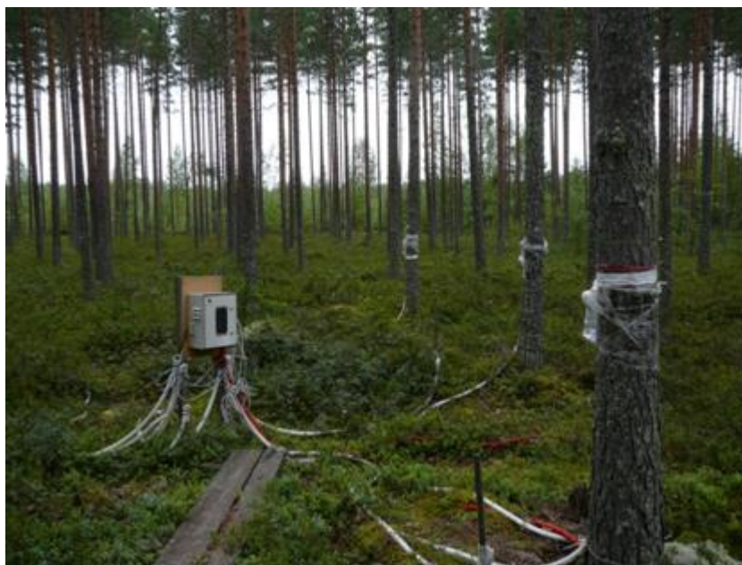
Attēls 37. Mērījumu veikšana ūdens cirkulācijas noteikšanai koka stumbrā
