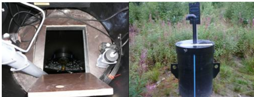
Attēls 36. Noteces mērījumu stacija Vilpula mežu pētīšanas stacionārā
