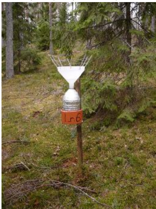
Attēls 4. Nokrišņu savācējs un nobiru uztvērēji objektā Zvēri
