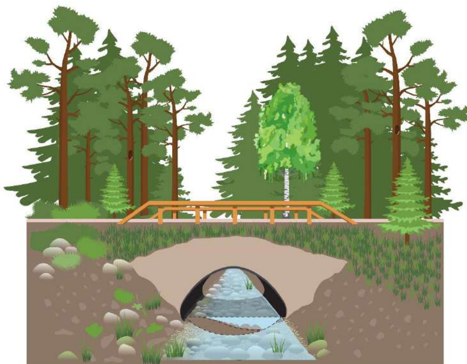
1.3.1 attēls. Dabai draudzīgākas caurtekas vizualizācija ar dažādām organismu grupām nozīmīgiem elementiem: caurteka ir vismaz ūdensteces platumā,; tā ir daļēji iegremdēta ūdensteces gultnē – caurtekā ir ūdensteces gultnei raksturīgais substrāts; mazūdens periodā tā var kalpot arī kā dzīvnieku pāreja (tunelis) sauszemes dzīvniekiem; koku un krūmu apaugums vismaz daļēji ir saglabāts ūdensteces krastos.
