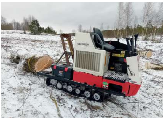
1.2.5. attēls. Lielo priežu stumbru novākšana ar mazgabarīta tehniku, kas aprīkota ar gumijas ķēdēm ziemā. Foto: Diāna Marga.
