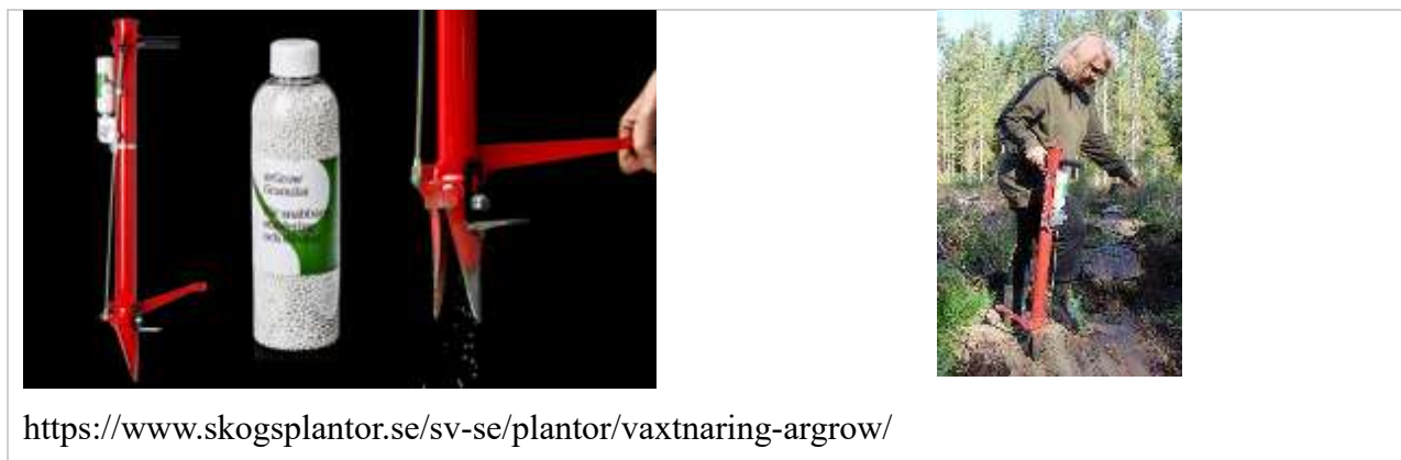
Attēls 1.22. Granulēta mēslojuma/biostimulanta AG ienesi stādvieta pielāgots stādāmais stobrs.
