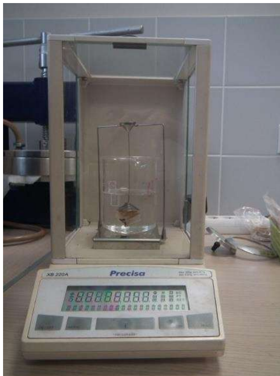
Attēls 6. Blīvuma mērīšanas process
