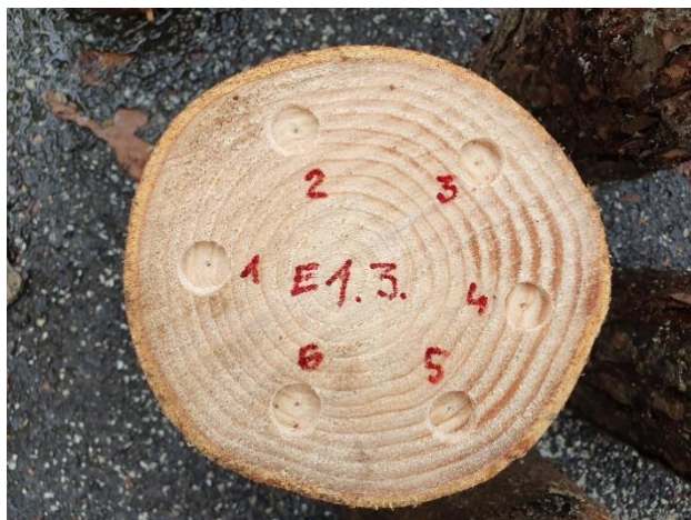
2.1.2. att. Bluķītis ar virsmā iestrādātām bedrītēm, kur iepilināta P. gigantea suspensija.
