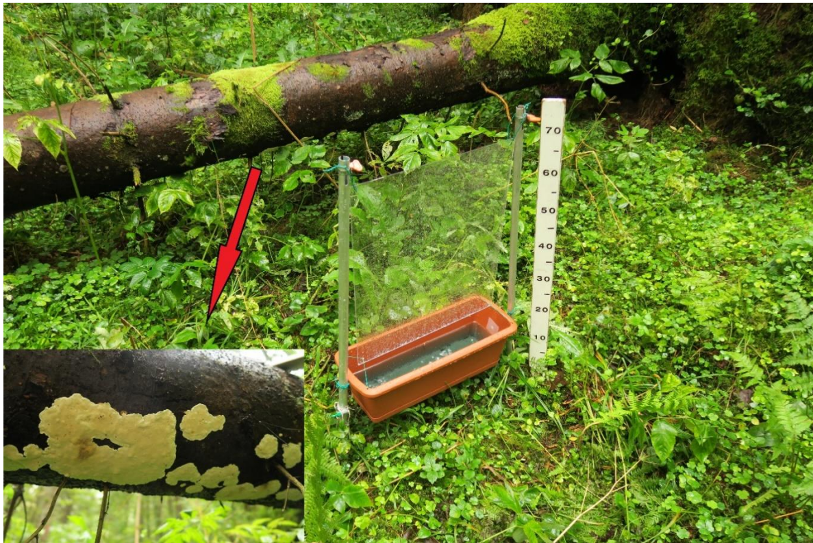
1.8.2. att. Logu slazds, kas izvietots pie izgāztas egles stumbra ar aktīvi sporulejošiem Heterobasidion augļķermeņiem.
