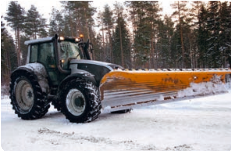
Ar sniega vērstuvi aprīkots traktors
