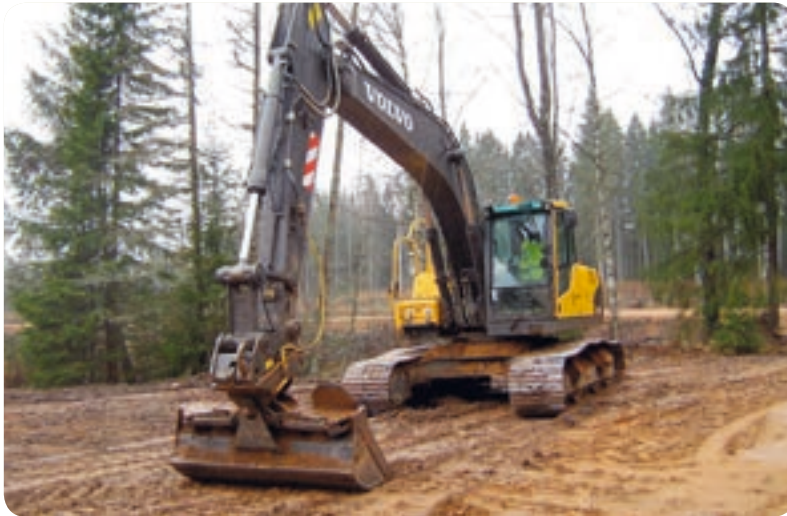
Ekskavators ar planējamo kausu nogāžu veidošanai
