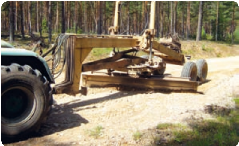
Profilēšanā izmantojamā uzkarināmā iekārta
