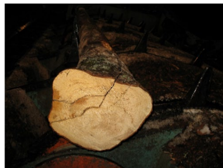
4. attēls. Gāšanas un sagarumošanas plaisa.
