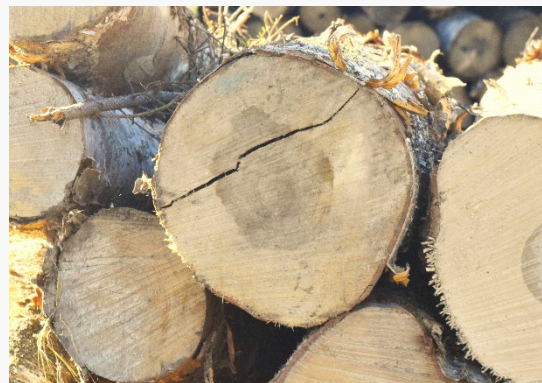
9. attēls. Gāšanas un sagarumošanas plaisa.
